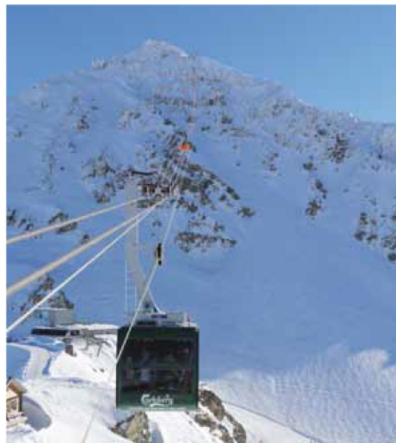
La cabine de 45 places se déplace à 10m/s offrant un débit horaire de 400 pers./h
