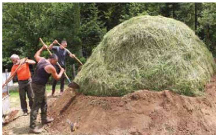
Après l'empilage debout des longues buches (650) en rond, cela en laissant une cheminée au milieu, elles ont été recouvertes d'herbe fraîche tassée et en finissant le tout est recouvert de terre (photo) et couve ainsi 12 tonnes de bois.
